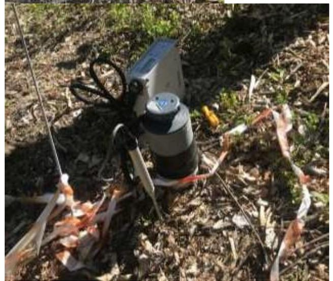
**Figura 16.** I sensori TREE TALKER © su un albero di castagno e camera di respirazione del suolo e strumento per la determinazione della CO<sub>2</sub> nello spazio di testa.
